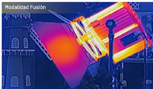
La tecnología Bi-Spectrum de Hikvision permite visualizar imágenes visibles y térmicas, y llevar a cabo la fusión de imágenes de doble espectro, creando una imagen híbrida única que proporciona detalles adicionales que permiten una fácil visualización y detección.
